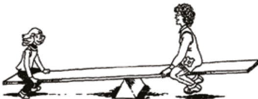
Figura 1 – Exemplo de utilização de uma alavanca. Supondo que o baloiço é simétrico, e que a criança tem menor massa, para equilibrar as forças, o adulto posiciona-se mais à frente, diminuindo esse braço da alavanca.
